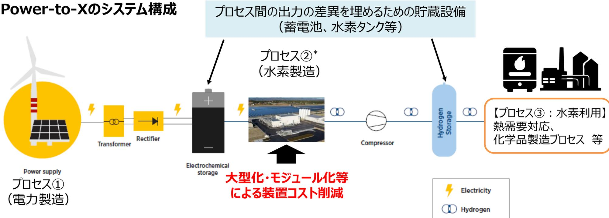
水電解装置の開発と合わせて、ボイラー等の熱関連機器や基礎化学品の製造プロセスとを組み合わせ、再エネ電源等を活用した非電力部門の脱炭素化に関するシステム全体を最適化する実証を行う予定
