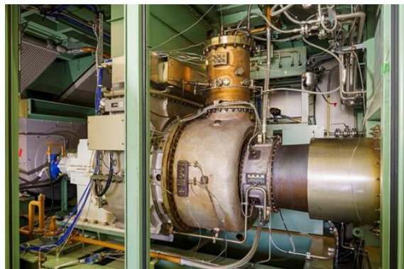
IHI製アンモニア専焼MW級ガスタービン
