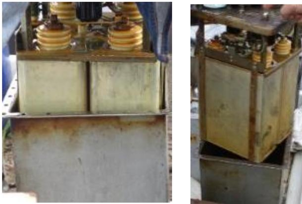
X線発生装置の低圧コンデンサーは一般に電源ユニットの蓋に取り付けられ絶縁油槽の中に漬け込まれて設置されている。
