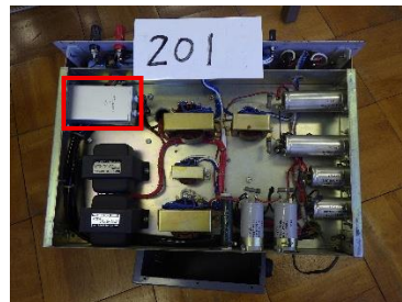
⑰電源装置(左)と装置内に設置された低圧コンデンサー(右)
