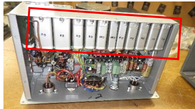
⑭ストロボ装置(左)と装置内に設置された低圧コンデンサー(右)
