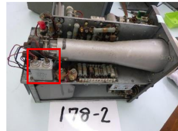
⑮ブラウン管オシロスコープ(左)と装置内に設置された低圧コンデンサー(右)
