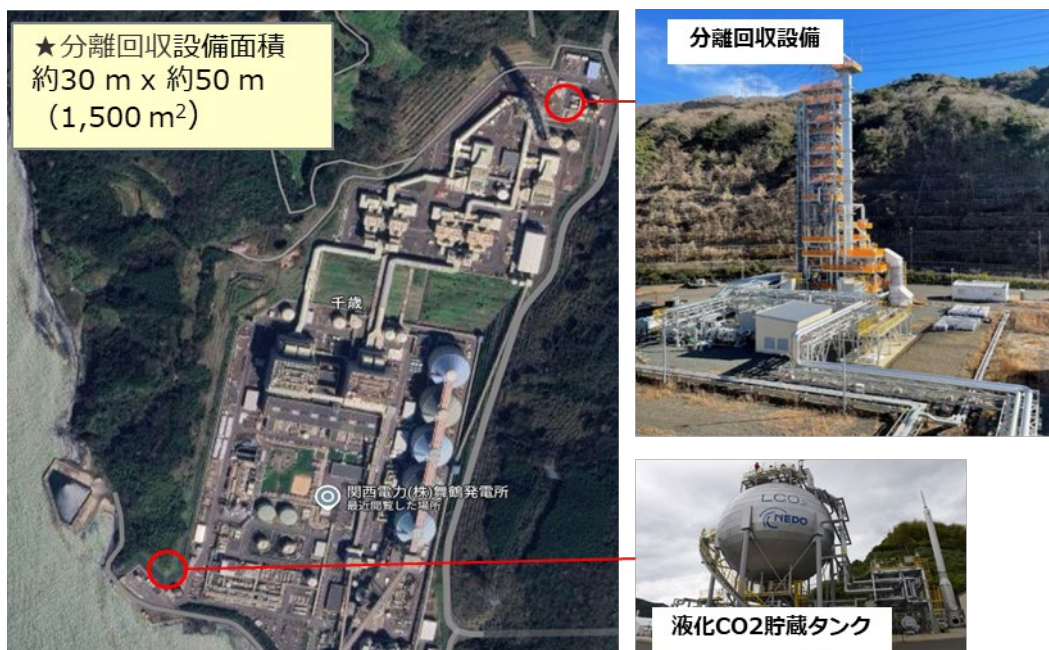
図 3-88 関西電力舞鶴発電所における CO 2 分離回収試験設備の俯瞰図、外観
