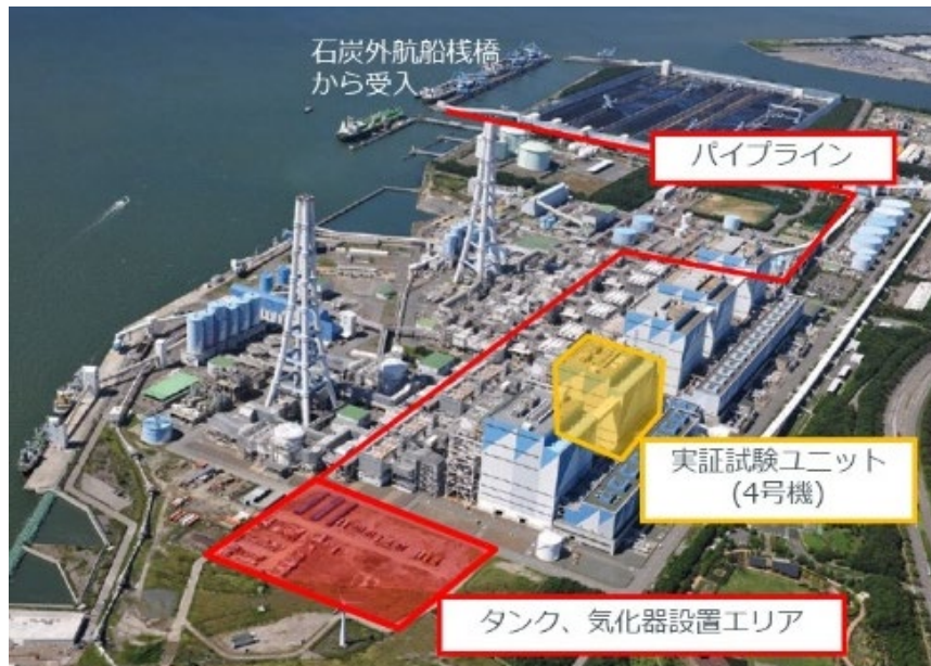
図 3-52 (IHI) 石炭、アンモニア混焼実証事業イメージ図_JERA 碧南火力発電所
