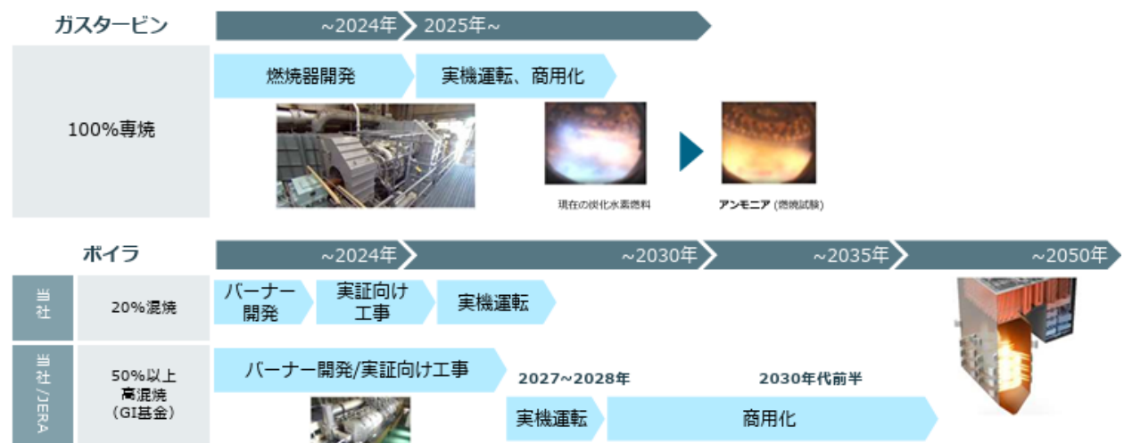
図 3-50 (三菱重工業) アンモニア発電設備の開発目標
