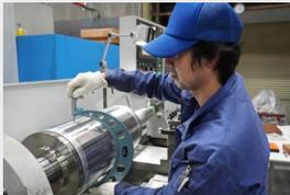
外注品、内作加工品問わず、出荷前検査を徹底しています。目視検査では、傷、欠陥、塗装の外観をチェックを欠かしません。寸法検査では、マイクロメータやノギスを使って寸法記録を作成します。加工中の不具合は、小さなことでもお客様に報告します。1/1000mmの公差部や幾何公差は3次元測定器を使って計測します。検査記録を取り、書面として残しておくことで厳しい原子力認定にも適合し、突発的な監査のときでも素早く、労力をかけずに対応することができます。
