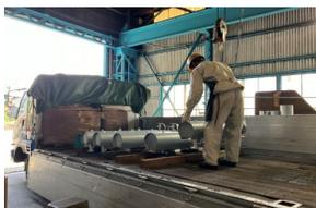
傷がつきやすいので積み込みの際は固縛後、シートをかぶせて養生し、積み込み検査を徹底しています。複数の客先向の製品を積み合わせて出荷し納入後は造船所にて組立が行われます。納入後のトラブルもほとんどなくお客様の作業がスムーズに行えます。
