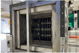
この熱交換器は、高い熱交換効率を誇り、特定の製作治具も自社専用に開発されています。高温条件下（800度から900度）でも安定して使用できる製品であり、他社にはない連続使用が可能な点が大きな特徴です。
