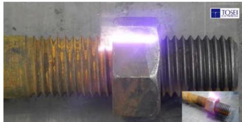
レーザークリーニング（ボルトの赤さびの除去）
