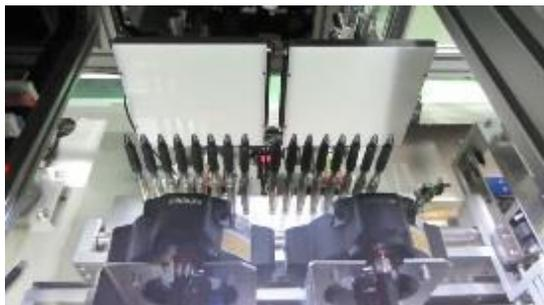
官能検査のデジタル化：外観検査装置
