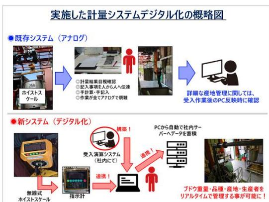
従来のブドウ受入方法（上段）と新たに構築したシステム（下段）
