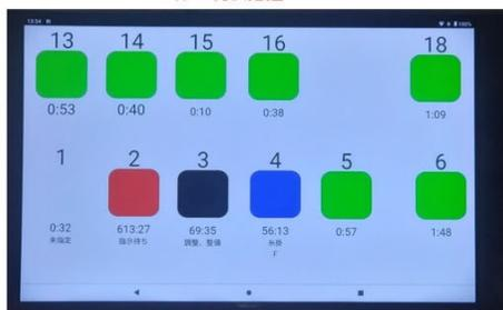
編機が停台すると自動で停止時間を計測
