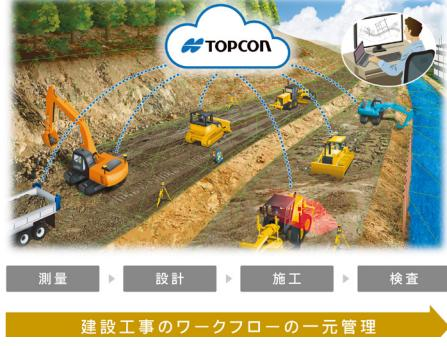
械や農業機械の位置を測り、地図や設計図面の情報と組み合わせることで運転の自動化を実現。建設や農業の作業の効率化に貢献できるようになりました。
