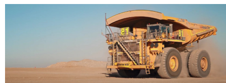
(図2) Lomas Bayas 銅鉱山（チリ）にて稼働するAHSダンプトラック
