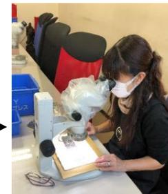
AIが不良品と判定した製品(約2万個)には不良品と良品が含まれるため、再度検査員が目視検査
