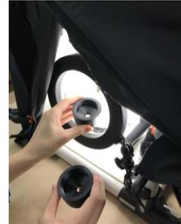
製品を箱より取り出し、AIが入った検査機械に人手で製品をセット。AIがOK・NGを判断
