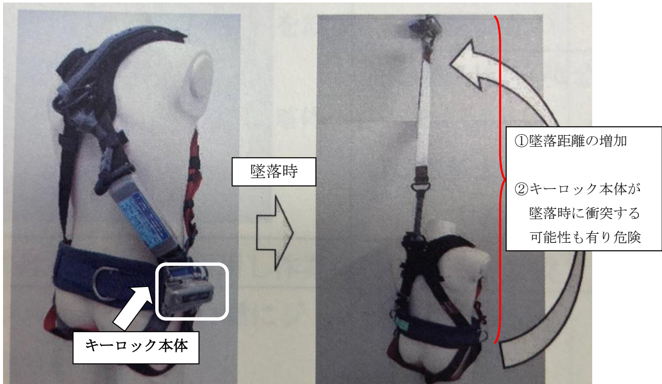
図2 「墜落制止用器具」としてのキーロック方式安全器具
