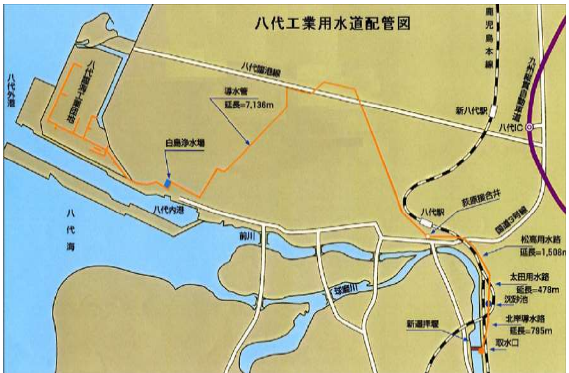
図 1.1.3 配管図（八代工水）
