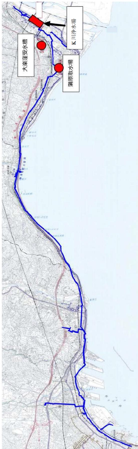
図 1.1.4 C 工業用水道（静清庵地区）施設位置及び配水管網図
