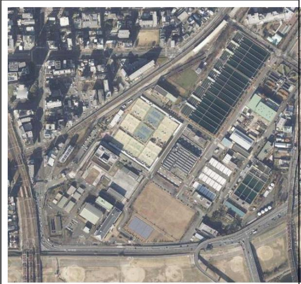
東淀川浄水場(上水道の処理施設である柴島浄水場と併設し、薬品注入設備や排水処理設備を共有)
