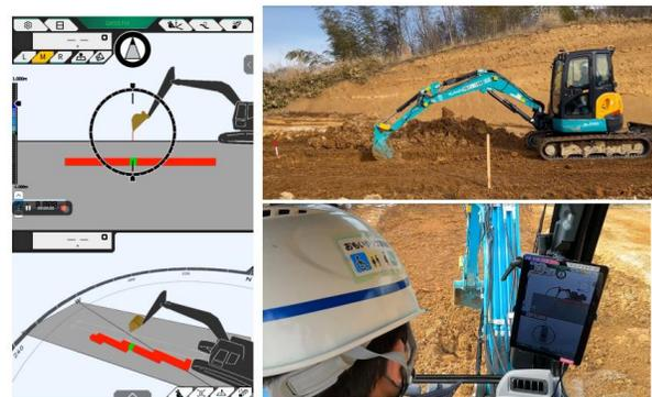
マシンガイダンスを用いて、施工目標を視覚化することで、建設機械の操作者の操作性を向上等
