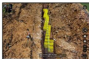
工事現場において、地下設備の埋設状況をバーチャル化して表示することで、埋設物損傷の事故防止に繋げる。
