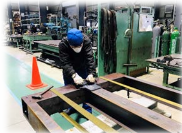
プレート溶接工程
