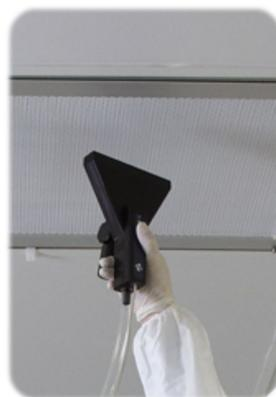
図 A2.6 スキャンプローブを用いた汚染源調査
