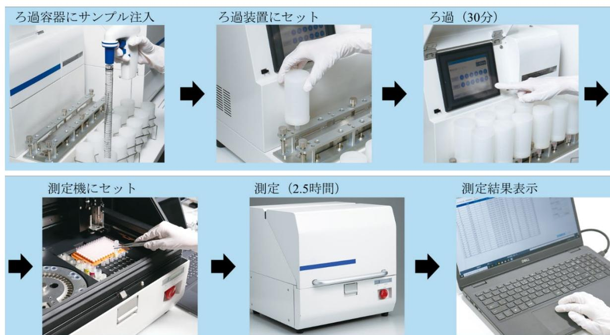
図 A2.10 High ATP 法を用いた微生物迅速試験装置での測定事例
