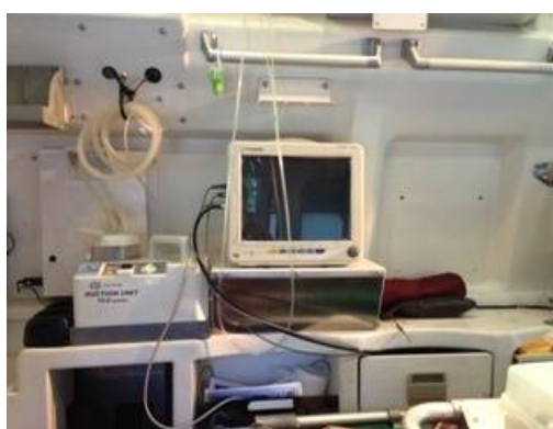
EAS 救急車内部（生体情報モニタ、吸引器） 生体情報モニタは中国製（OEM）
