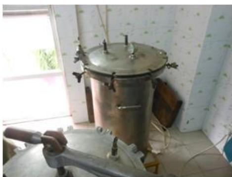
両病院とも煮沸式滅菌装置を使用。高圧蒸気滅菌装置による完全滅菌が望ましい。
