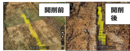
<地面を透過して埋設物を表示> 出典：Earthbrain
