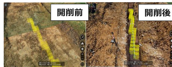
＜地面を透過して埋設物を表示＞ 出典：Earthbrain
