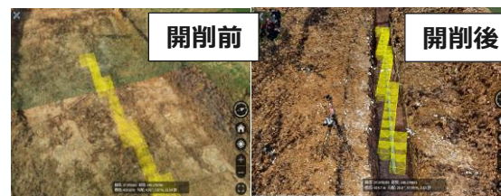
＜地面を透過して埋設物を表示＞ 出所：Earthbrain
