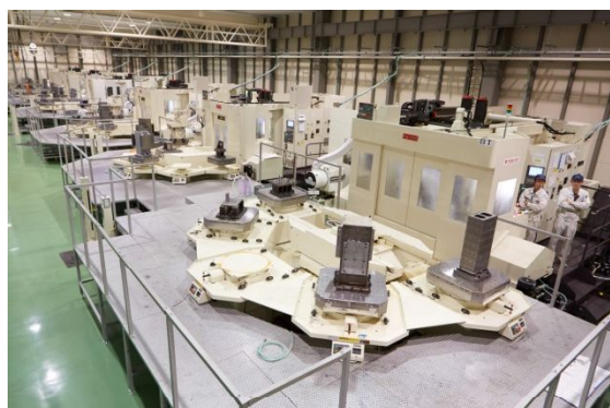
【大型 5 軸マシニングセンタ (前橋工場)】
