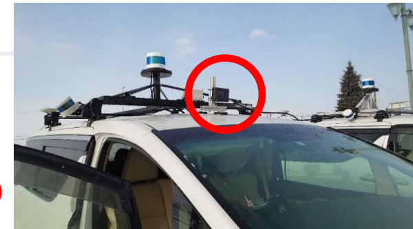
イメージングレーダの仮設置状況
