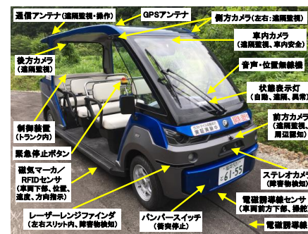
スマートEカートの装置構成例
