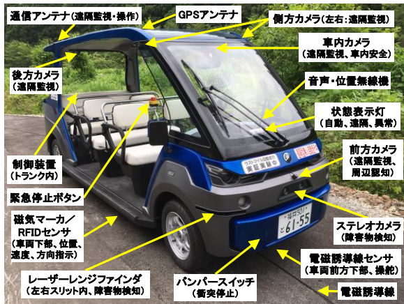
スマートEカートの装置構成例
