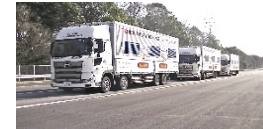
2020年11月 産業総合技術研究所テストコース （車速：80km/h, 車間距離：9m）
