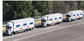
2020年3月 産業総合技術研究所テストコース （車速：30km/h, 車間距離：9m）
