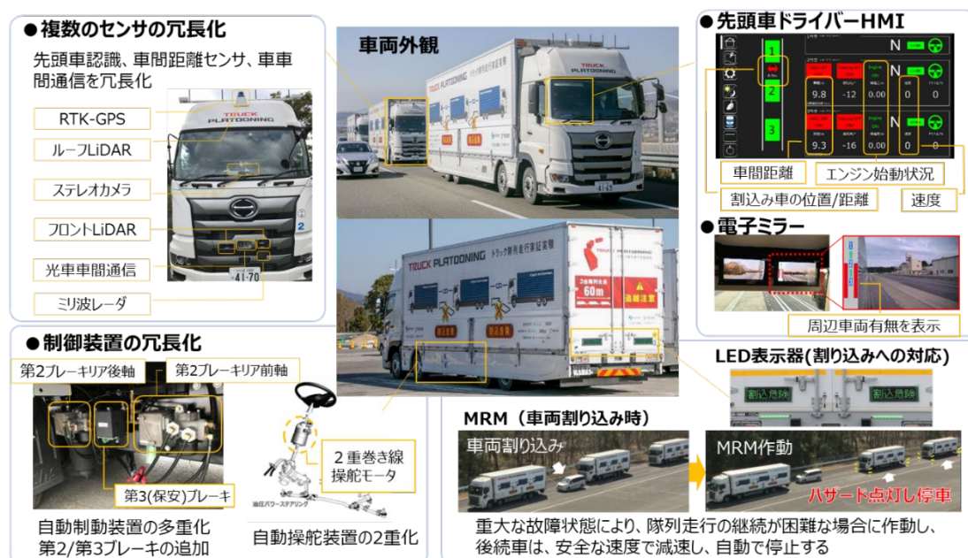
図 8. 後続車無人隊列走行技術の実現に向けた車両開発概要
