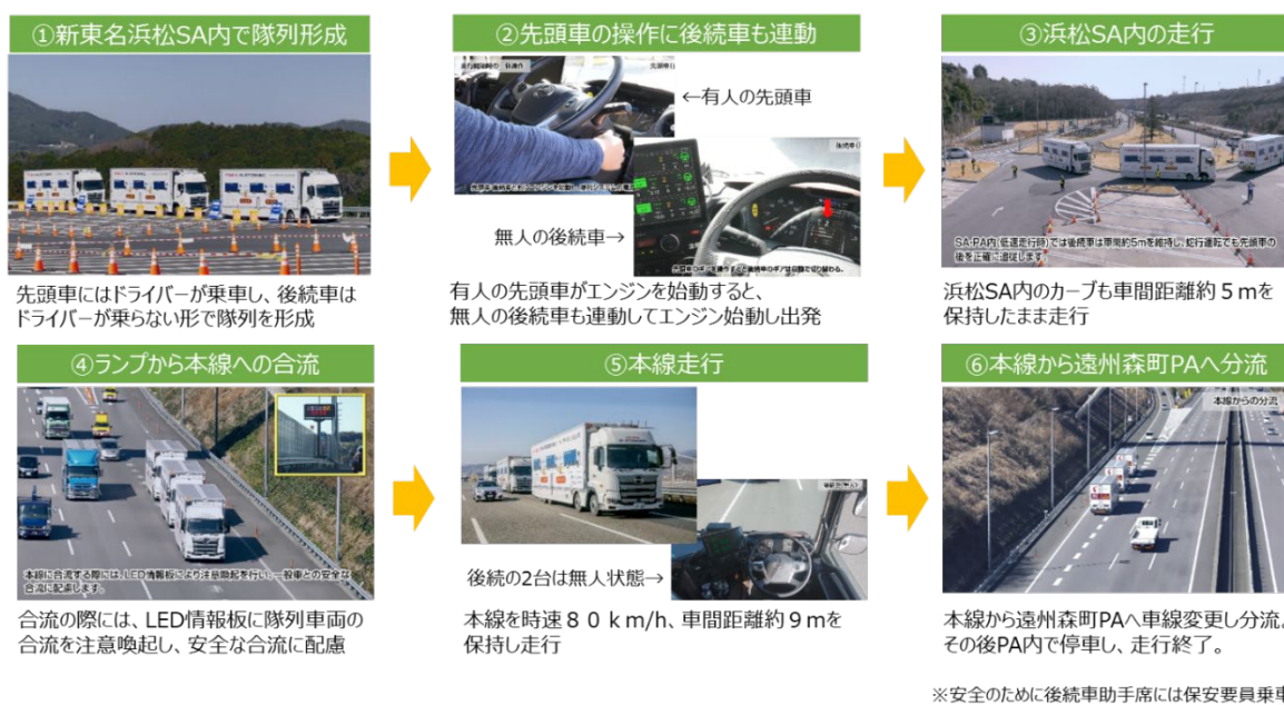
図 9. 高速道路におけるトラックの後続車無人隊列走行技術の実現の様子
