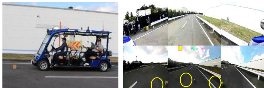
15cm角の障害物試験と停止後の遠隔監視モニタ確認
