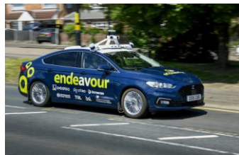
Endeavor Projectで使用されたL4相当の自動運転タクシー（セーフティドライバー付）
