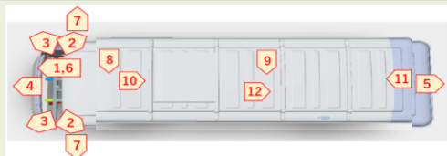
＜自動運転バスにおける遠隔監視カメラの現状設置案＞
