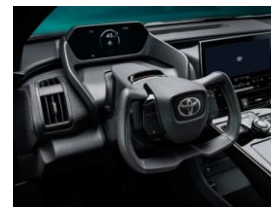
ステア・バイ・ワイヤによる 異形ハンドル （トヨタより）
