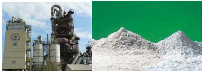
図 5-2-5 北九州市の北九州エコプレミアムに認定されている新日鐵高炉セメント(株)の高炉セメント B 種及び高炉スラグ微粉末
