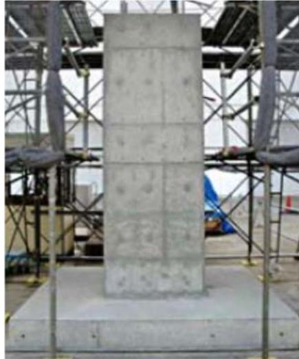
図 2-3-5 ECM セメントを用いた構造体
