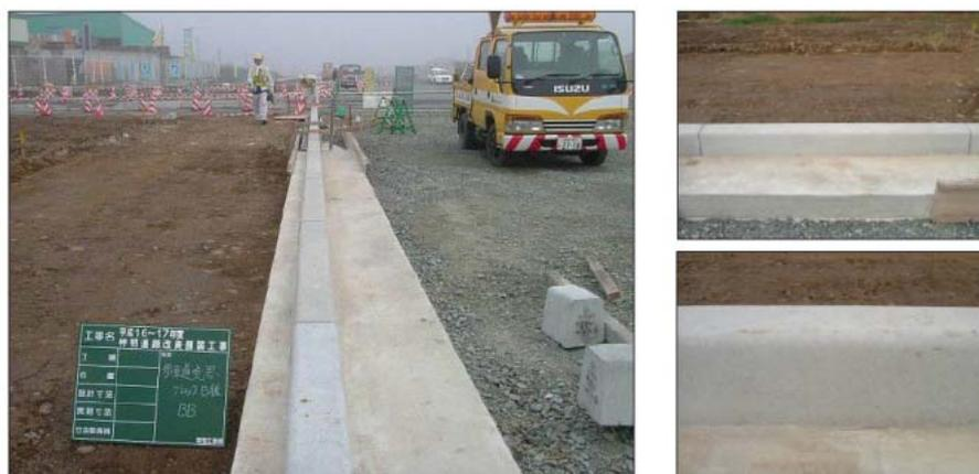
高炉セメントコンクリート二次製品のフィールド試験の様子1
