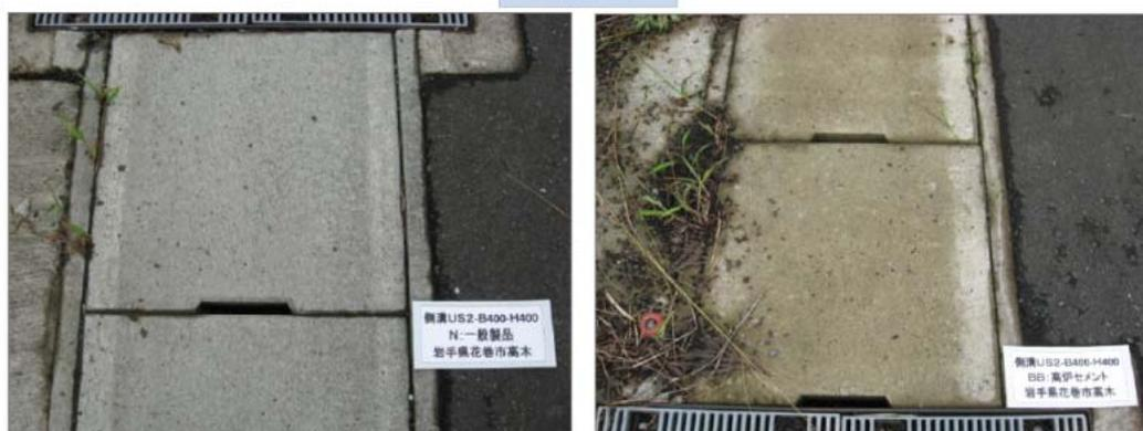
高炉セメントコンクリート二次製品のフィールド試験の様子2(左が普通ポルトランドセメント右が高炉セメント)
