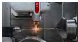
切削加工用シャフトへのDEDコーティング (出所) DMG森精機ホームページ
