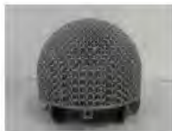
AMで製造された衝撃吸収材 (出所) 日本積層造形(株)HP
