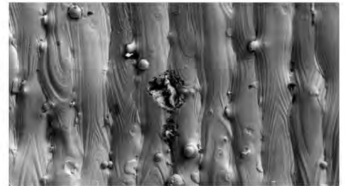
ステンレス鋼部品表面の孔食のSEM像
