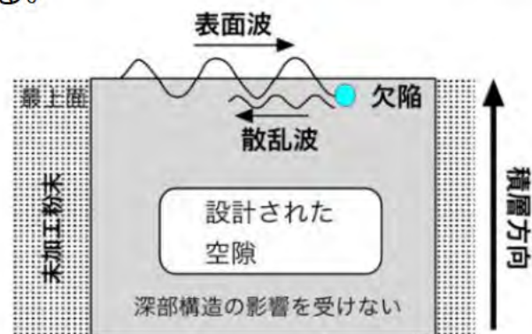
レーザ超音波を用いたインプロセス評価のイメージ
