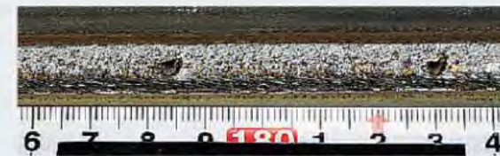
ビード外観(ピット)
