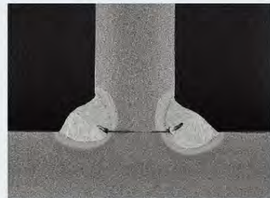
ビード断面写真(ブローホール)
