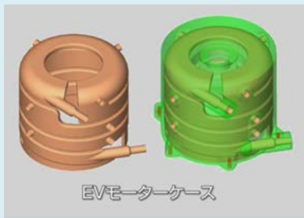
複雑形状の一体型砂鑄型の例
