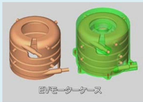
複雑形状の一体型砂鋳型の例
