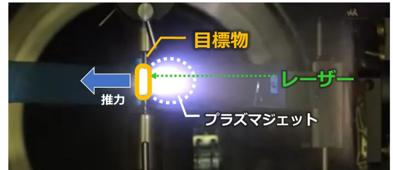
アルミニウムにレーザーを照射した際のアブレーション発生の様子
