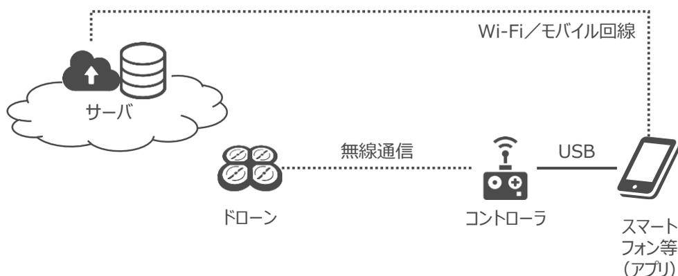
図 5-4 ドローンのネットワーク構成例
