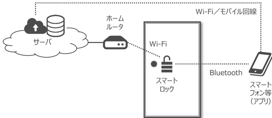
図 5-2 スマートロックのネットワーク構成例
