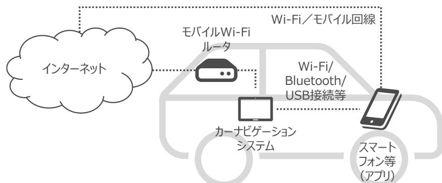
図 5-7 カーナビゲーションシステムのネットワーク構成例
