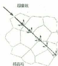
図 1 超音波の散乱・減衰のイメージ
