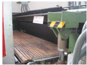
盤の目状にエンボス加工をして接着する熱ローラーがポイントである。2~4人でラインを動かす。
