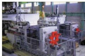
ドイツ製の成型機。ペレットを投入してエコプラスチック製品に成型加工する。
