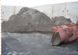
溶融スラグ…路盤材など土木用資材になる。下水道のクッション材として管の周囲に巻く材料にも応用されているそう。
