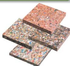
廃プラの再生樹脂ボードを製作している工場は全国でも二、三社である。断熱・防水・防音性に優れ、穴あけや釘打ちなどの加工ができる、コンクリートが付着しにくいので転用回数が増すという特徴を持つ。
