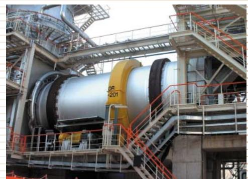
有価金属リサイクル施設のキルン溶融炉、シュレッダーストなどの原料が1,200°Cで焼却溶融処理される。
