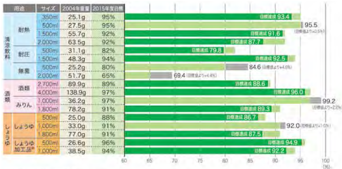
図 - III -2 サイズ・用途別 PET ボトル軽量化目標と実績 (2014 年度)
