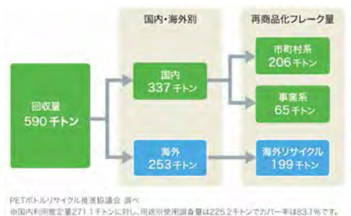
図-IV-9 2014 年度 PET ボトルの回収 / 再商品化の流れ
