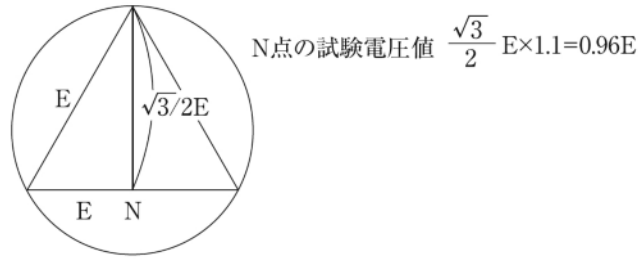
解説16.2図 (e) スコット結線変圧器のT座巻線と主座巻線の接線点の試験電圧
